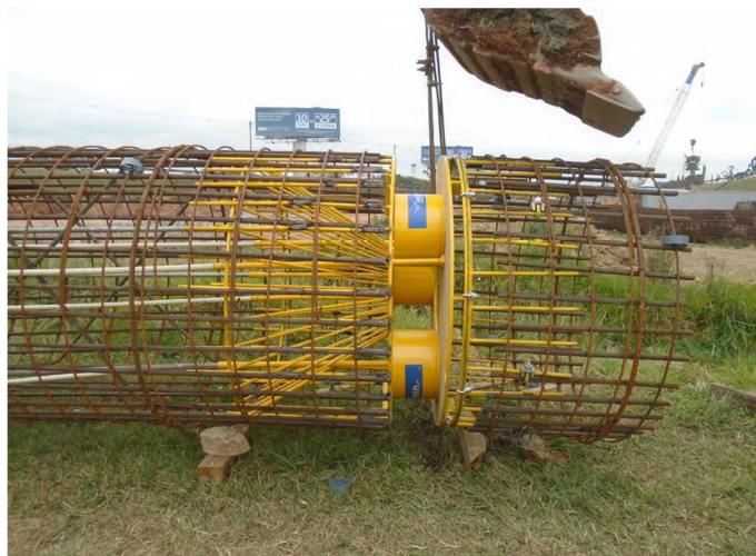
Figura 2.7 - Detalhe das células expansivas fixadas na armação da estaca
