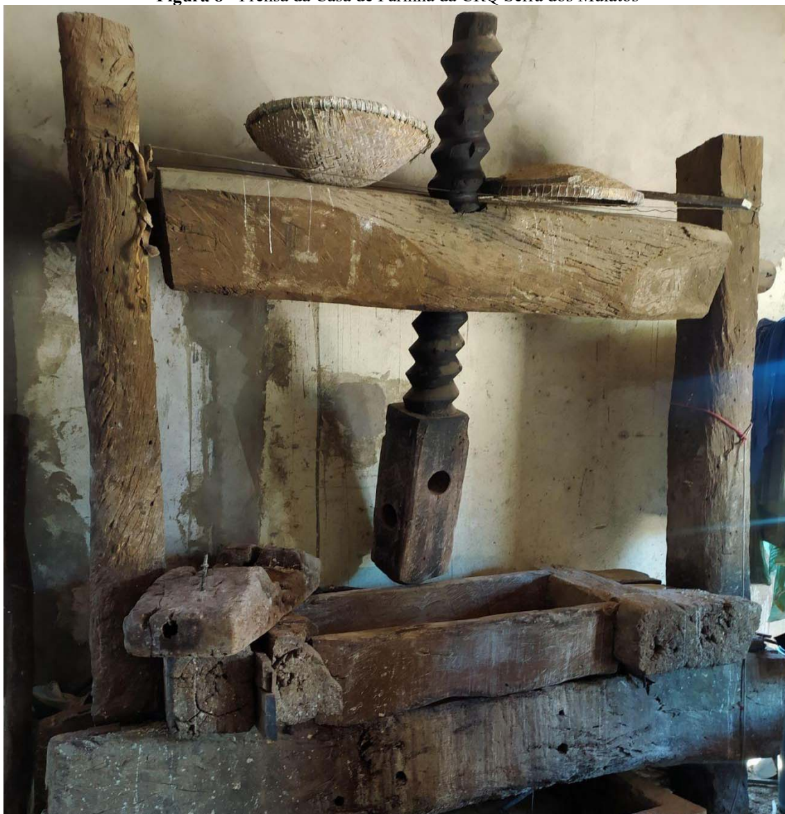
Figura 8 - Prensa da Casa de Farinha da CRQ Serra dos Mulatos
