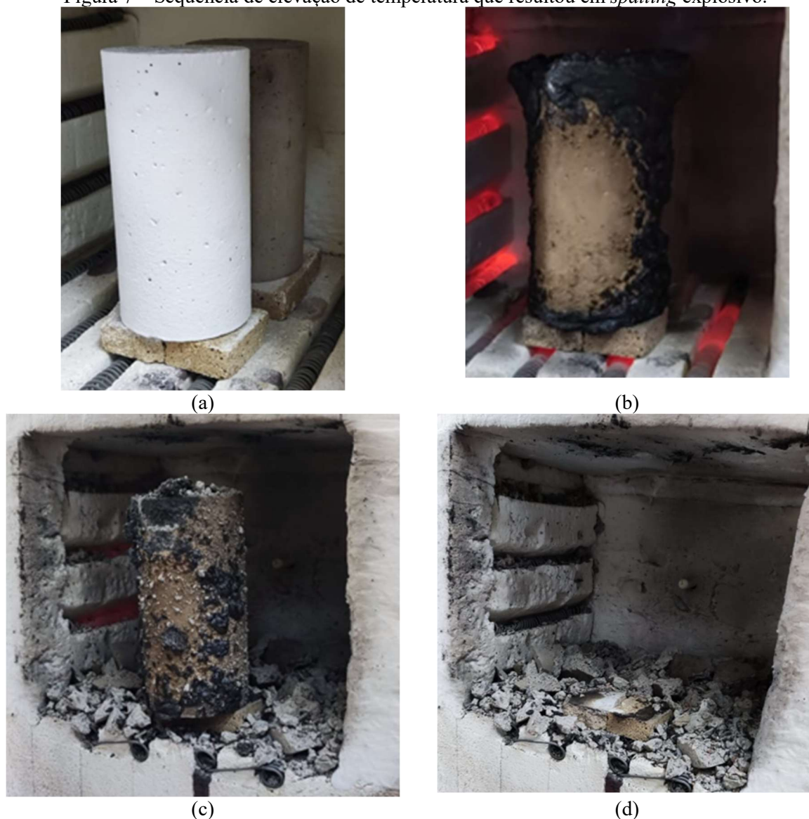
Figura 7 – Sequência de elevação de temperatura que resultou em spalling explosivo.
