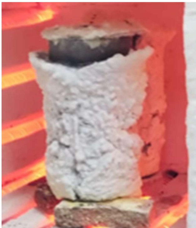
Figura 10 - Corpo de prova a 665 °C
