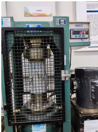
Figura 4 - Teste de compressão utilizando prensa hidráulica.
