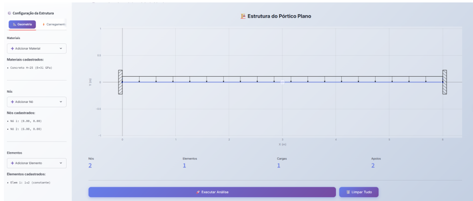
Figura 17 – Esquema estrutural do Exemplo 1: viga biengastada de seção constante.
