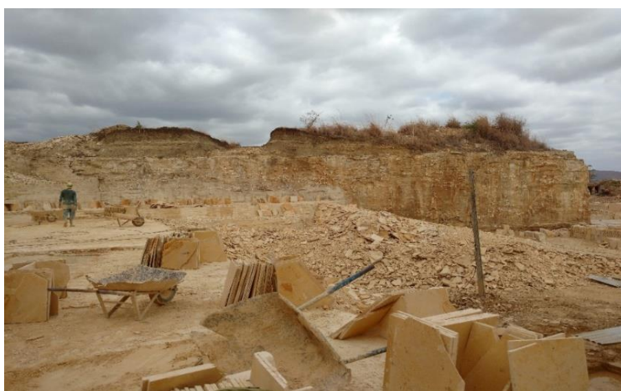
Figura 2 - Amontoados de resíduos da Pedra Cariri em Nova Olinda-CE, proveniente dos processos de extração.
