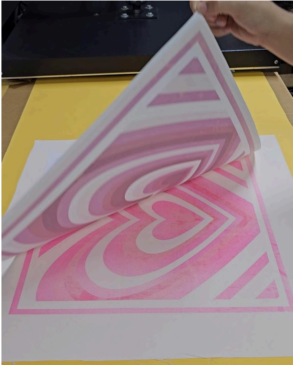
Imagem 22 - Processo de sublimação utilizando prensa
