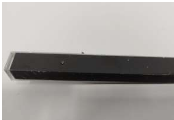
Figura 23. Falhas de processamento no corpo de prova. Fonte: Autor (2026)
