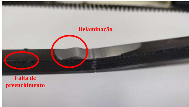
Figura 28. Defeitos de processamento dos compósitos. Fonte: Autor (2026)
