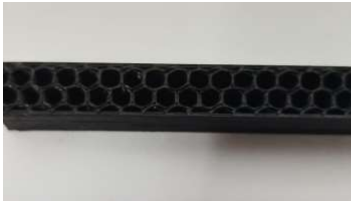
Figura 19. Reforço do corpo de prova impresso em geometria honeycomb . Fonte: Autor (2026)
