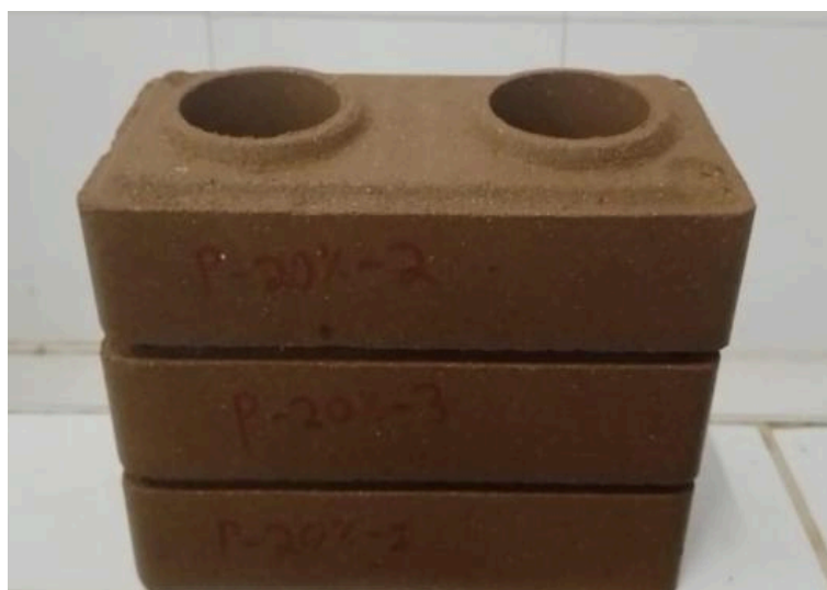
Figura 6 – Conjunto de três blocos em seu estado saturado, logo após suas pesagens
