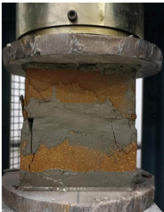
Figura 5 – Ensaio de resistência à compressão em prisma do tijolo solo-cimento
