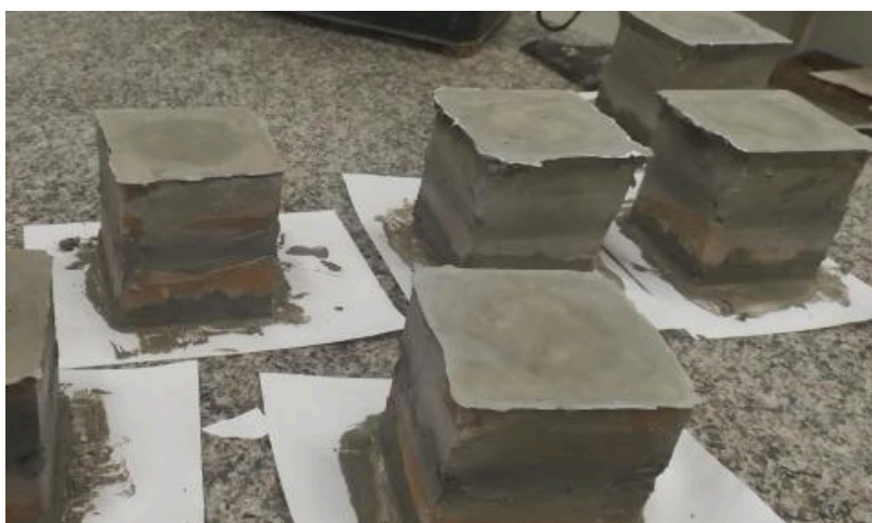
Figura 4 – Preparação dos tijolos como papel molhado para evitar a aderência do cimento à superfície da mesa
